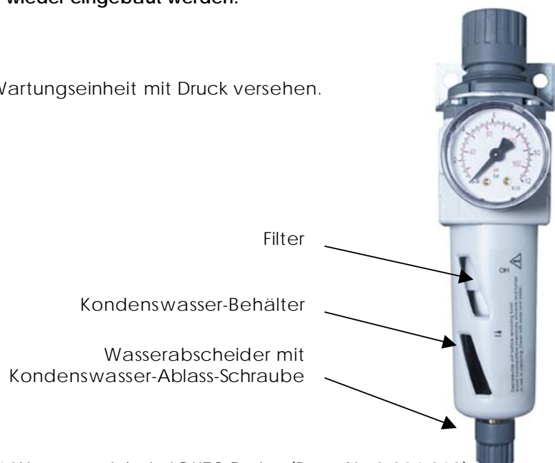
Bild 9.1 Wartungseinheit JOKE® Dryjet (Best.-Nr. 0 004 060)
